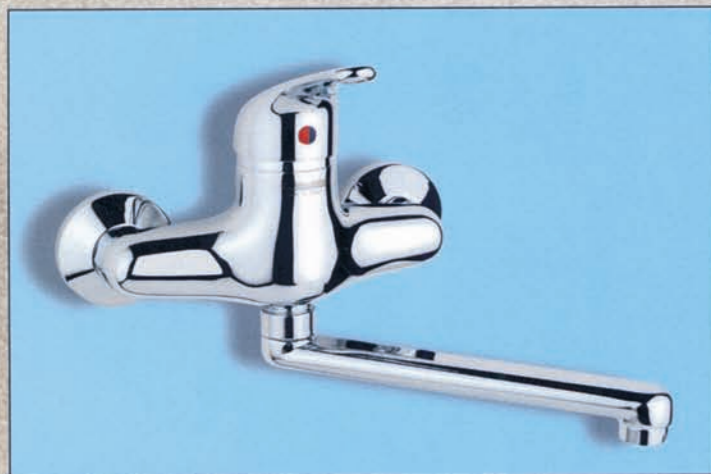
Art. 033 MISCELATORE MONOCOMANDO LAVELLO A PARETE Bocca di erogazione girevole mm. 200 o 300, eccentrici da 1/2" regolabili per interasse da mm. 150±15 WALL-MOUNTED SINGLE LEVER SINK MIXER Swivel spout mm 200 or 300, s-tailpieces with 1/2" connections, centre distance mm 150±15
